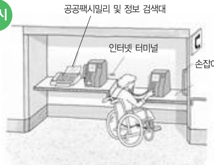
●공중전화 및 정보검색대 설치 예시
